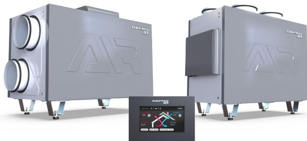
Производительность до 350, 450, 550 (200 Па), теплообменник противоточного типа и нагреватель предварительного подогрева, стандарт фильтров грубой очистки G4/ISO  $\geq 65\%$ . Исполнение - сталь, соединительные элементы - DN 200 мм в двух вариантах: горизонтальном (H) и вертикальном (V).
