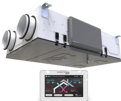
Производительность до 350, 450, 450 (200 Па), теплообменник противоточного типа, автоматический перепускной канал (байпас) и нагреватель предварительного подогрева, стандарт фильтров грубой очистки G4/ISO  $\geq 65\%$ , а также система балансировки потока. Исполнение - сталь, соединительные элементы - DN 200 мм.
